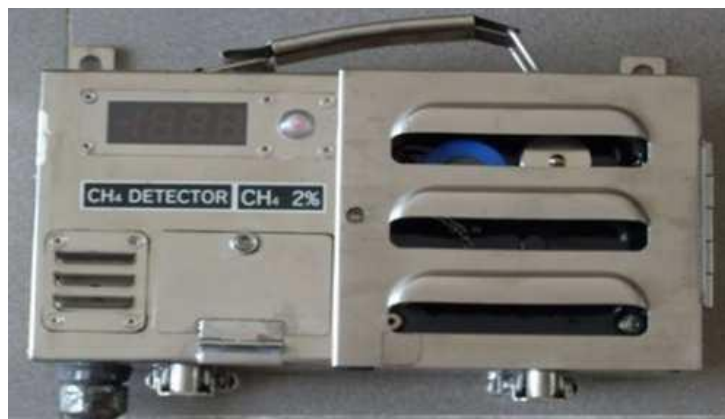
1.7 - сурет – Датчик метан MS-08
